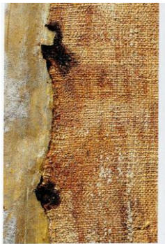
ภาพที่ 3: ภาพตัวอย่างความเสียหายที่เกิดจากความชื้นสูง ทำให้ตะปูที่ยึดผ้าใบ เกิดสนิมขึ้นและส่งผลทำให้บริเวณผ้าใบเกิดรอยฉีกขาด ที่มา : จัดทำโดยนางสาวดาเลีย เลิฟเร็ก, เมื่อวันที่ 25
