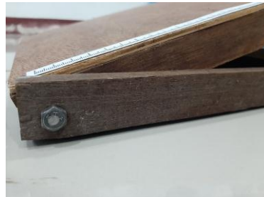
รูปที่ 2 การยึดไม้ด้วยนอตหรือสกรูเพื่อทำให้เกิดจุดหมุน
