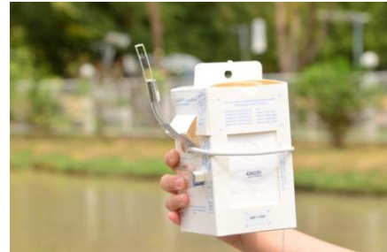
รูปที่ 2 เซนเซอร์วัดอุณหภูมิและความชื้นสัมพัทธ์ ของวิทยุหึ่งอากาศ
