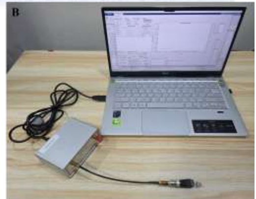
รูปที่ 1 แสดงแผนผังการทดสอบสำหรับการวิเคราะห์เทคนิคควอตซ์คริสตัลไมโครบาลานซ์ (A) แผนภาพจำลองของอุปกรณ์ทดสอบ (B) ภาพถ่ายอุปกรณ์การทดลองจริง
