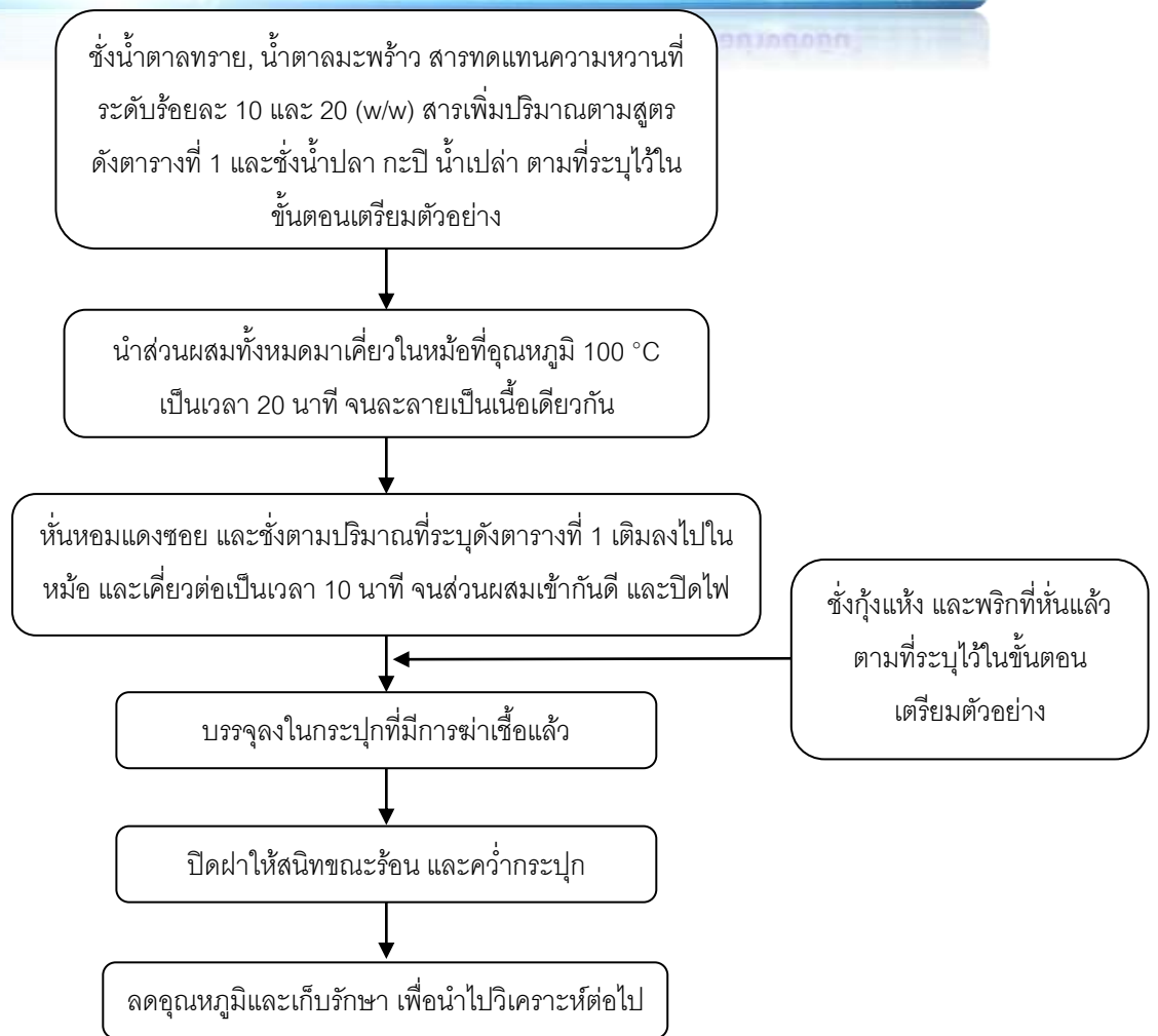
ภาพที่ 1 แผนภาพกระบวนการการผลิตผลิตภัณฑ์น้ำปลารสหวานสูตรควบคุมและสูตรที่ใช้สารทดแทนความหวาน ได้แก่ Trehalose, Sucralose และ FOS ที่ระดับการทดแทน 10 และ 20%
