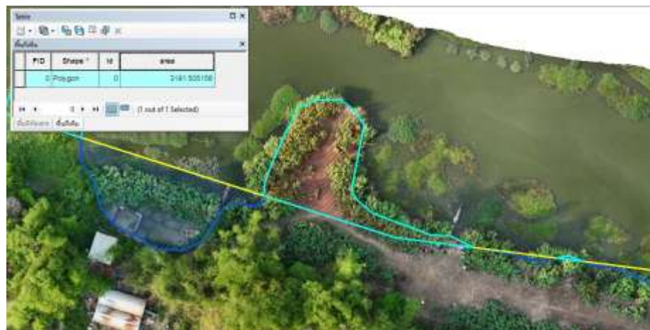
รูปที่ 5 การวิเคราะห์เชิงพื้นที่และเปรียบเทียบหาปริมาณพื้นที่งอก-กัดเซาะ โดยโปรแกรม ArcMap
