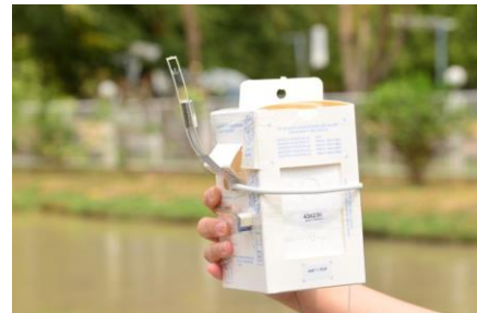
รูปที่ 2 เซนเซอร์วัดอุณหภูมิและความชื้นสัมพัทธ์ ของวิทยุหึ่งอากาศ
