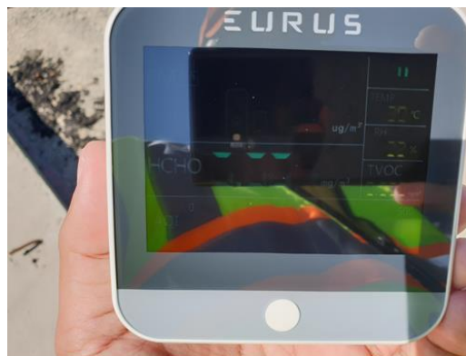
ภาพที่ 1 เครื่องมือวัดปริมาณฝุ่นละอองแบบพกพา ยี่ห้อ EURUS รุ่น AQM001
