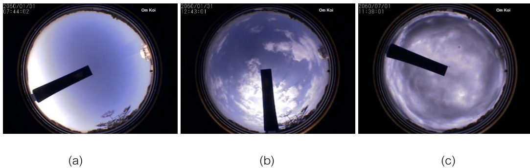
รูปที่ 2 ตัวอย่างภาพถ่ายท้องฟ้าจากเครื่องถ่ายภาพท้องฟ้า ของสถานีเรดาร์ฝนหลวง อำเภออมก๋อย จังหวัดเชียงใหม่ ในกรณีสภาพท้องฟ้า (a) ปราศจากเมฆ (b) มีเมฆบางส่วน (c) มีเมฆปกคลุมเต็มท้องฟ้า
